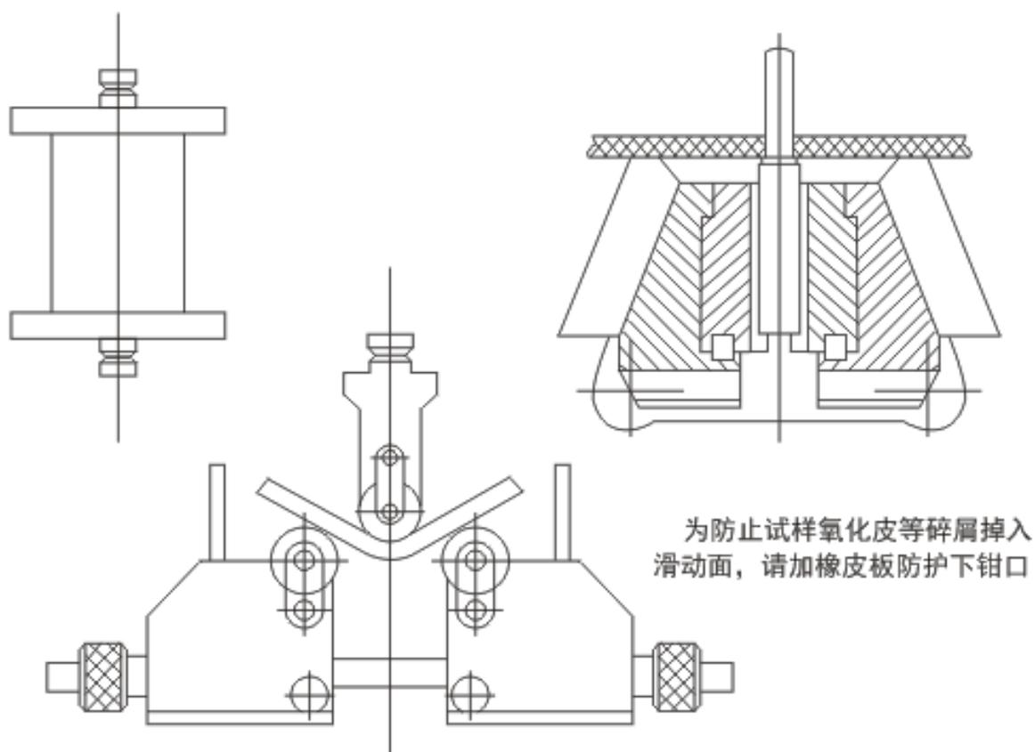
附图3 压缩、拉伸、弯曲试验试样装置图
